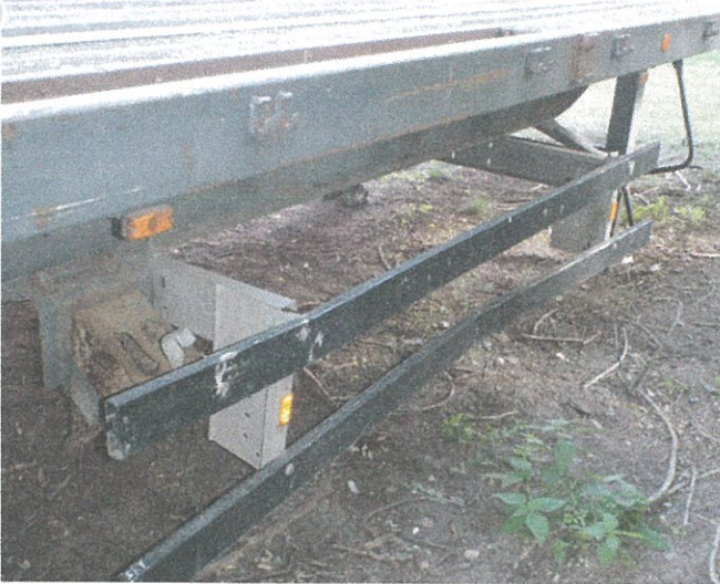
jobb oldali aláfutásgátló deformált
