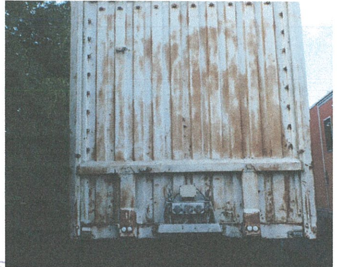
plató frontfalkorrodált, festék hiányos
