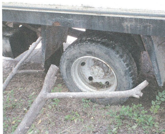
gk.váz sok helyen korrodált
