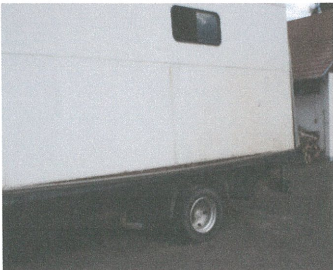
szegélyléc lóg, korrózió
