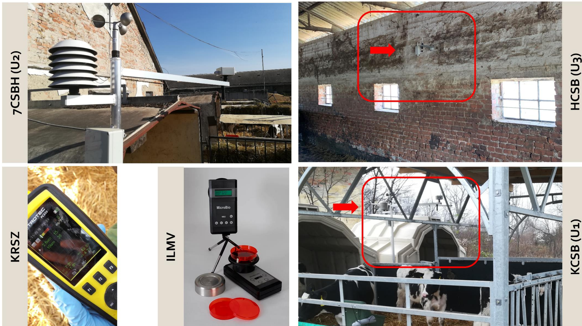
2. Ábra Az egyes telepített monitoring eszközök elhelyzése a borjúnevelő egységekben, illetve az alkalmazott kézi mérőeszközök.
