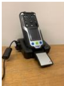
Dräger X-AM8000 készülék a levegő \text{CO}_2 tartalmának mérése
